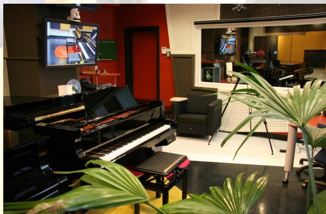
Murs isolés et panneaux acoustiques mobiles permettant de modifier la résonance spatiale du local. Deux pianos acoustiques 7'6" avec capteurs optiques et systèmes d'exploitation MIDI intégrés pour l'enregistrement.
